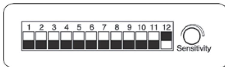
Setzen Sie den DIP-Schalter 12 auf „ON“ (= Ein, obere Schalterstellung). Das Gerät wird nun vom Takt der Musik gesteuert. Mit jedem Impuls der Musik schaltet das Gerät auf eine andere Farbe um. Sie können die Empfindlichkeit für diese Betriebsart mit dem Regler „Sensitivity“ einstellen.
