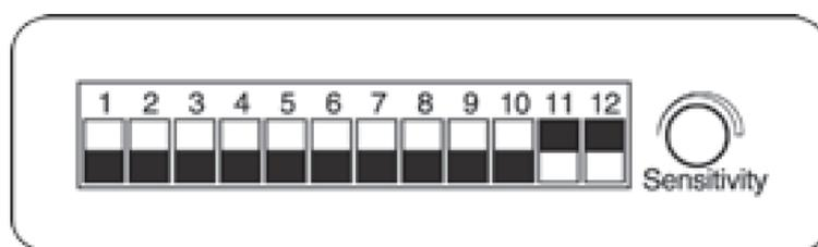
Setzen Sie die DIP-Schalter 11 und 12 auf „ON“, um das Gerät in den Mischfarbenmodus zu schalten. Sie können die Zeit zwischen den einzelnen Farbübergängen mit den DIP-Schaltern gem. folgender Tabelle einstellen.
