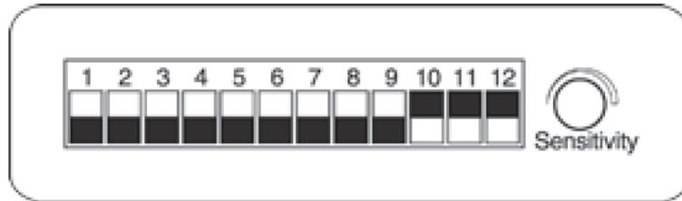
Setzen Sie die DIP-Schalter 10, 11 und 12 auf „ON“, um das Gerät in den manuellen Modus zu versetzen. Dann können Sie die Helligkeit der einzelnen Farben gemäß der folgenden Tabelle einstellen:
