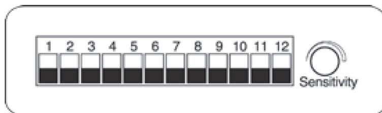
Setzen Sie die DIP-Schalter 10, 11 und 12 auf „OFF“ (= Aus, untere Schalterstellung), um das Gerät in den DMX-Modus zu versetzen. Es lässt sich nun mit jedem DMX-Controller steuern. Mit den DIP-Schaltern 1-9 wählen Sie die DMX-Kanäle im Bereich von 1 - 507 aus. Dabei steht DIP-Schalter 1 für Kanal 1, Schalter 9 steht für Kanal 256.
